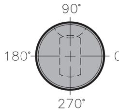
**!** La forme est réalisée par défaut à T=90° du logement de bille, suivant croquis ci contre.
