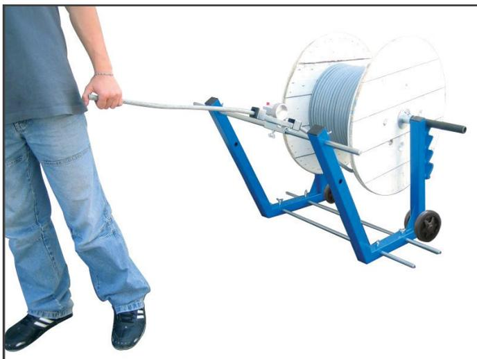
Déroulement très souple grâce aux centreurs en aluminium ( $\varnothing$  78 mm), qui tournent sur un axe en acier ( $\varnothing$  35 mm)
