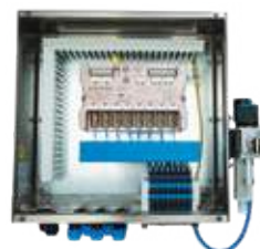
Coffret zone 1 avec E/S déportées avec pilotage d'électrovanne
