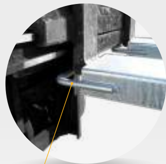
Étriers de retenue sur les 2 fourches
